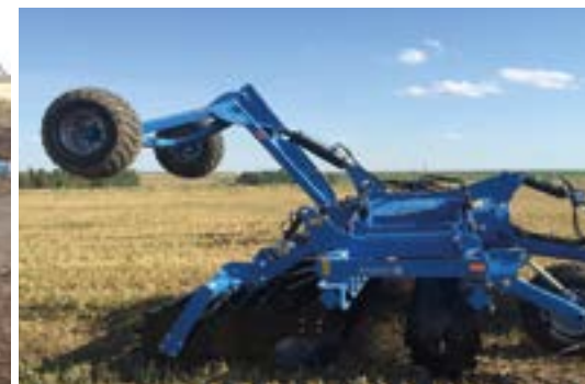
Ausführung gezogen mit Fahrgestell hinter der Walze - Arbeitsstellung
