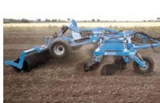
Ausführung gezogen mit Fahrgestell vor der Walze - Arbeitsstellung
