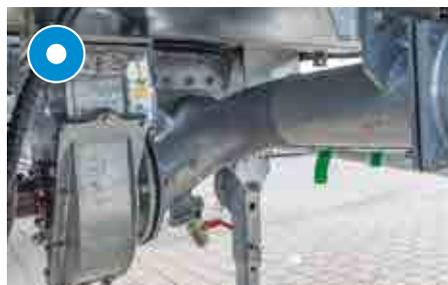
Turbobefüller hydraulisch, mittig unter dem Fass
