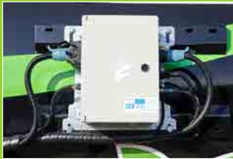
Schaltschrank FFC mit integriertem Jobrechner und ISOBUS-Schnittstelle
