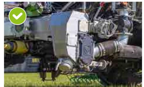
Äußerst wartungsfreundlich: Mechanisch angetriebene Drehkolbenpumpe inkl. Reduziergetriebe
