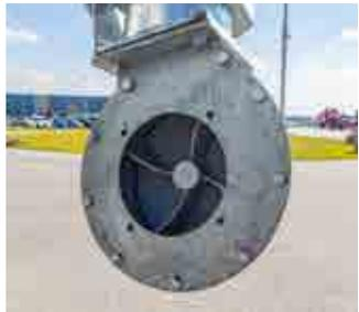
Saugausleger Transfill - bedienbar über Joystick-Steuerung, Proportionale Bedienung. Komplette ausgefahren ca. 10 m. Flexibler Einsatz durch stabilen Drehkranz und drei Gelenken. Enorme Saugleistung durch Turbobefüller am Ende des Auslegers.
