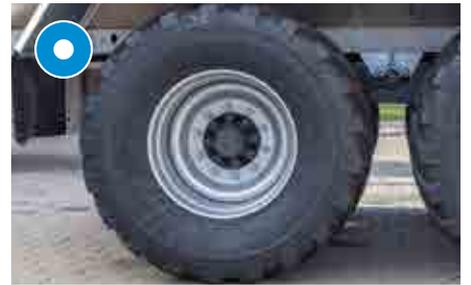
Bereifung bis max. 26,5" möglich
