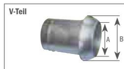
Dieses System hat am **M-Teil einen beweglichen Ring**, an der die Hebel angebracht sind. Das **V-Teil hat einen Konus** und besteht aus nur einem Teil. Um die Größe der Perrot-Kupplung zu ermitteln, müssen Sie entweder den äußeren Durchmesser des V-Teils oder den Innendurchmesser des M-Teils messen. Die Kupplungsschlauchtülle wird außen oder am inneren Schlauchdurchmesser gemessen.
