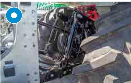
Dreipunkt hydraulik wird beim Lenken der Achse mitgeführt
