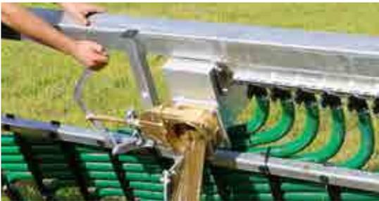
Staukasten für Fremdkörper, mechanische oder hydraulische Entleerung
