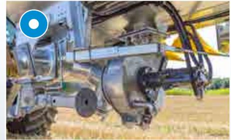
Bei Vakuumfass: Turbobefüller mittig unter
