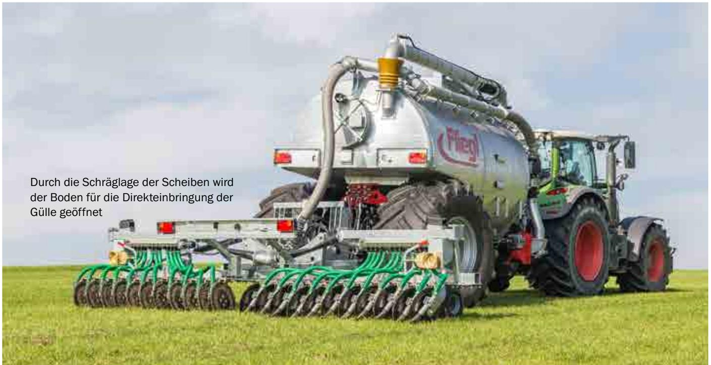
Durch die Schräglage der Scheiben wird der Boden für die Direkteinbringung der Gülle geöffnet
